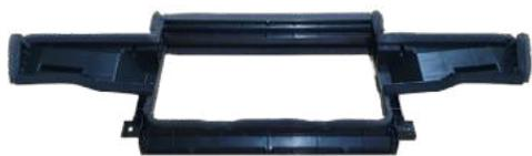
의 없었는데, 해당 장비를 활용함으로써 자동차 외장부품 개발에 큰 도움이 되었다. 특히, 에스피엘의 보유 장비로는 개정된 수요처의 시험 스펙을 만족할 만한 수준의 결과를 도출하기 어려웠지만, 신뢰성바우처를 통해 FITI시험연구원의 전문인력 및 장비들을 사용함으로써 R&D 부품의 내구성에 대한 신뢰성을 도출해낼 수 있었다. 한편, SUV D Segment 차량에 적용되는 인터쿨러 가이드의 복합진동내구시험 중 제품의 일부에서 변형이 일어나 신뢰성에 문제가 되기도 했다. 그러나 평가를 진행하던 연구원이 제품의 안착 방향 및 조립 볼팅에 대한 전문적 의견을 제시했고, 이에 따라 공정 수정 후 평가를 재실행했다. 그 결과, 수요처가 요구한 시험 스펙에 적합한 결과를 얻을 수 있었다.
